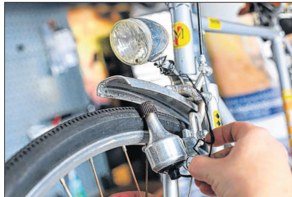
Brennt das Licht noch? Sonst alle Kabel überprüfen. Stecken sie fest drin, sind sie gebrochen?
