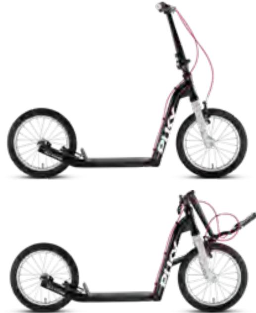
Mit klappbarem Lenkervorbau, V-Brakes, 16"-Alu-Laufrädern und Kick-Ständer.
