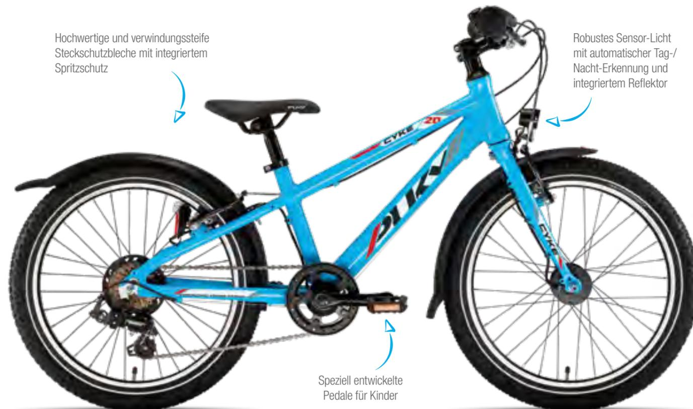
Speziell entwickelte Pedale für Kinder
