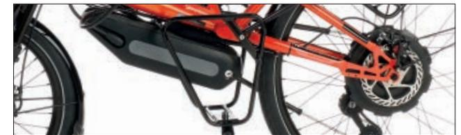
Oben: Der Akku wird mit tiefem Schwerpunkt ideal in der Mitte des Rades unter dem Sitz angebracht. Platz dafür bieten alle HP VELOTECHNIK Liegeräder mit Obenlenkung, die *Streetmachine Gte* auch mit Untenlenkung. Zum Laden kann der abschließbare Akku einfach abgenommen werden.
