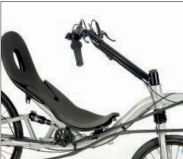
Den *Deichsellenker* bieten wir an für *Speedmachine* und *Grasshopper fx*. Er kombiniert eine entspannte Armhaltung mit einer guten Aerodynamik. Vorteil beim Transport: Der *Deichsellenker* baut erheblich schmäler als der *Aerolenker*. Zusätzlicher Vorteil auf dem *Grasshopper*: Da können Sie den *Deichsellenker* zum Einsteigen locker nach vorne klappen.
