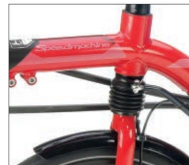
So können Sie bei scharfen Kurven sicher einlenken: Die schlanke Gabel der *Speedmachine* statten wir Ihnen auf Wunsch mit dem *CONCEPT* Steuerkopf-Feder-system aus. Durch die kompakte Bauweise kann die Kette eng am Rahmen entlang und komplett über dem Vorderrad laufen. Die leichte, verwindungssteife und komfortable Konstruktion lässt sich individuell einstellen und ist ausgesprochen wartungsarm. 50 mm Federweg
