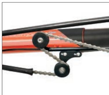
*Rahmenschnellverstellung*: Zwei Schnellspanner, und schon lässt sich Ihr Rad im Handumdrehen auf unterschiedliche Beinlängen einstellen. Die von HP VELOTECHNIK für Messe- und Vorführäder entwickelte Technik mit 15 cm Verstellbereich hat für Sie den Vorteil, dass Sie das Rad zu Transportzwecken in Sekunden kleiner machen können: einfach Ausleger einschieben.
