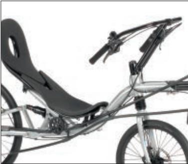
Ob Sie einen *Oberlenker* als *Aerolenker* oder *Deichsellenker* (Bild Mitte) wählen oder sich einen *Untenlenker* wünschen: Letztlich ist das eine Frage der Ergonomie und wie man sich am wohlsten fühlt. Der *Aerolenker* sorgt für eine sportliche, gestreckte Armhaltung und optimale Aerodynamik. Tourenfahrern bietet er zudem reichlich Platz, damit sie ihr digitales Equipment direkt im Sichtfeld unterbringen können.
