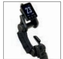
geht, spricht: Die dicken Plus- und Minus-Tasten zum Durchschalten der Unterstützungssufe kann man gar nicht verfehlen.
