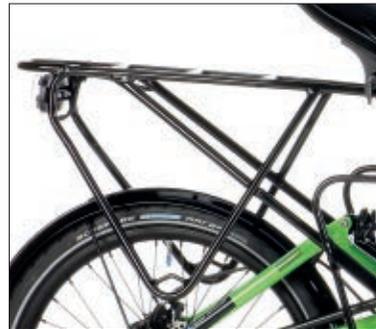
Für alle drei Zweiradmodelle bauen wir speziell geformte Träger aus hochfestem Alu-Rohr mit 2 mm starken Wänden und einem Durchmesser von 12 mm. So fährt Ihr Gepäck voll gefedert, was ein optimales Federverhalten ermöglicht und gleichzeitig das Material schont. Die Konstruktion bietet reichlich Platz für Ihre Ausrüstung und gibt den Packtaschen mit den Seitenbügeln sicheren Halt. Sinnvoll integriert: Ein Schutzbügel für Ihr Rücklicht und ein Wimpelhalter.
