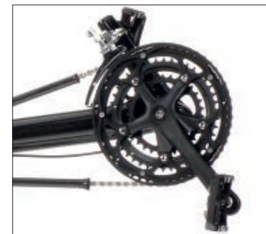
Die leichtere Lösung: Bei Dreifach-Kettenblattgarnitur verbauen wir anstelle des Rammschutzes auch eine Kettenschuttscheibe. Das spart 150 Gramm Gewicht und sorgt für eine saubere Kettenführung. Nur in Kombination mit Schaltung SHIMANO XT 30 Gang oder mit Motor von NEODRIVES erhältlich.
