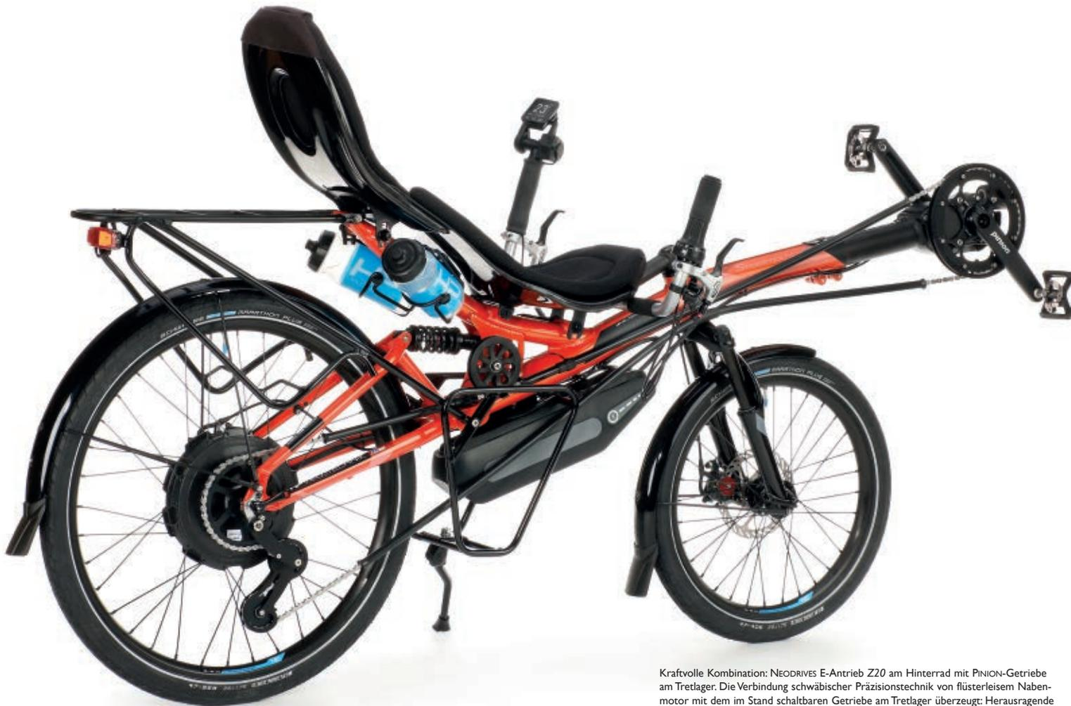
Kraftvolle Kombination: NEODRIVES E-Antrieb Z20 am Hinterrad mit PINION-Getriebe am Tretlager. Die Verbindung schwäbischer Präzisionstechnik von flüsterleisem Nabemotor mit dem im Stand schaltbaren Getriebe am Tretlager überzeugt: Herausragende Funktionalität, wartungsarmer Betrieb, ausgewogene Gewichtsverteilung und komfortable Bedienung mit dem extralangen Drehschaltgriff von HP VELOTECHNIK.
