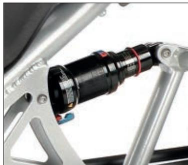
Luftfedererlement *Monarch RL* von ROCK SHOX. Praktisch: Per mitgelieferter Pumpe kann die Federhärte an die Zuladung angepasst werden. Mit einer einstellbaren hydraulischen Zugstufendämpfung und blockierbarer Druckstufe ausgestattet, überzeugt der Dämpfer mit hervorragendem Ansprechverhalten in unseren Tests. 262 g Gewichtsersparnis gegenüber dem Stahlfedererlement DNM DV-22.
