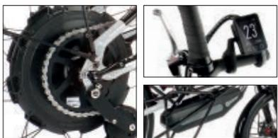
Der optionale elektrische Hilfsantrieb von NEODRIVES unterstützt Sie bis 25 km/h aus dem flüsterleisen Hinterrad-Nabenmotor: 5 Unterstufungsstufen, 40 Nm Spitzendrehmoment. Reichweite bis 145 km. Bergab können Sie per Rekuperation dem leichten Li-Ionen-Akku (612 Wh / 36 V) Energie zurück geben. Anfahrhilfe auf Knopfdruck bis 4 km/h.
