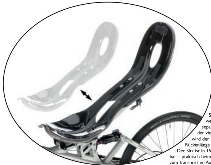
Die anatomisch geformte Sitzschale und Rückenlehne werden per Schnellspanner separat verstellt. Nach dem Lösen der vier Schrauben in der Mitte wird der Sitz stufenlos auf Ihre Rückenlänge justiert. Der Sitz ist in 15 Sekunden komplett abnehmbar – praktisch beim Abstellen im Regen oder zum Transport im Auto.
