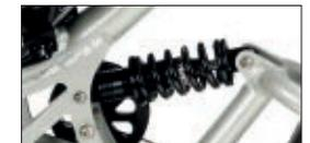
Das **Herzstück**: Federelement für die Hinterradschwinge mit Stahlfeder und hydraulischer Dämpfung. Durch Verdrehen der Feder können Sie die Federvorspannung ohne Werkzeug fein auf Ihre Zuladung einstellen. Für die grundlegende Anpassung an das Fahrergewicht stehen einfach austauschbare Federn in verschiedenen Federhärten zur Verfügung.
