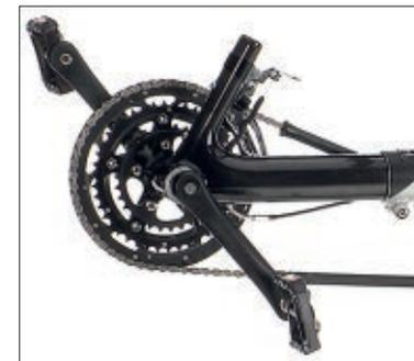
Edles für die Auslage: Mit dem Tretausleger aus Sichtcarbon setzen Sie ein tiefschwarzes Glanzlicht an optisch herausragender Stelle. Gewichtsersparnis gegenüber der Aluminium-Front: 170 Gramm. Carbon-Ausleger bieten wir sowohl mit Umwerferrohr an als auch ohne; ohne nur in Kombination mit Nabenschaltung.
