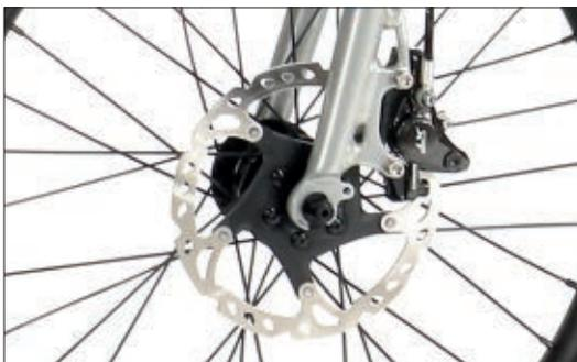
Daran führt kein Weg vorbei: Die Bremse ist eine Scheibe. Alle Zweirad-Modelle von HP VELOTECHNIK sind mit Scheibenbremsen ausgestattet. Prunkstück ist die hydraulische SHIMANO XT, wahlweise kommen aber auch die mechanische BB7 von AVID oder die Hydraulik-Disc Auriga von TEKTRÖ zum Einsatz.
