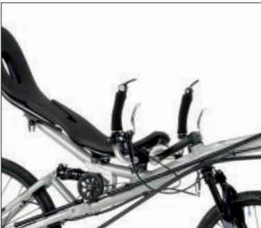
*Untenlenker* gelten als die komfortablere Variante: Einfach locker die Arme baumeln lassen und locker aus der Hüfte lenken. Allerdings ist der *Untenlenker* nicht mit allen Optionen unseres Baukastensystems kompatibel: An *Grasshopper fx* oder *Speedmachine* schließt ein *Untenlenker* die Kombination mit *ErgoMesh XL-Sitz* ebenso aus wie einen Motor. Für den bequemen *ErgoMesh XL-Sitz* auf der *Streetmachine Gte* bieten wir als Sonderbauform den *Breiten Untenlenker* an.
