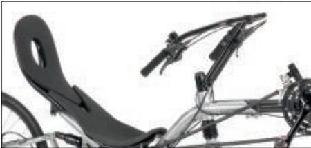
Der Aerolenker sorgt für eine sportliche, gestreckte Armhaltung und optimale Aerodynamik. Viel Platz zwischen Lenker und Oberkörper für einfaches Einsteigen. Großer Lenkeinschlag und präzise Kurvensteuerung.
