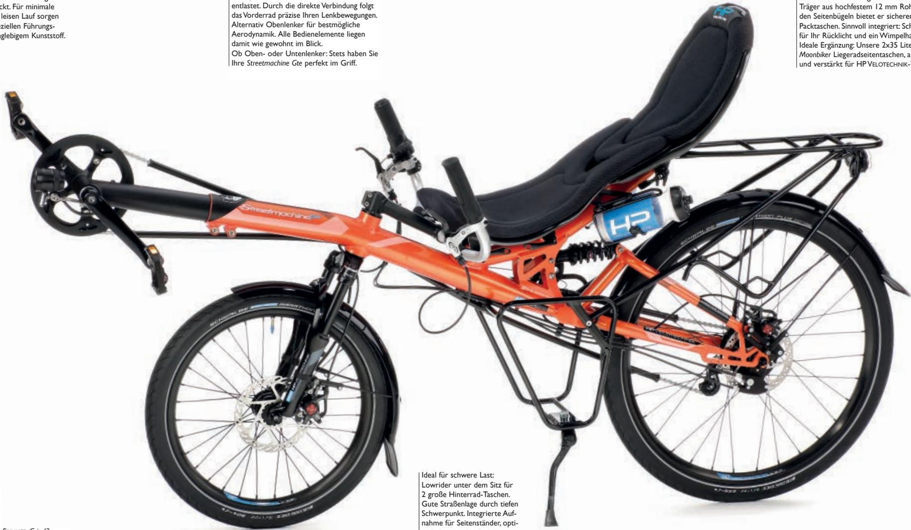
Hochwertige SPINNER Grind2 20" Federgabel mit einstellbarer Federvorspannung und austauschbaren Stahlfedern. Die serienmäßigen Scheibenbremsen garantieren zuverlässige Bremskraft selbst auf langen Bergabfahrten oder bei Nässe und schonen die Felgen vor Verschleiß.
