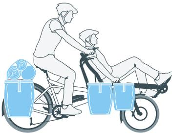
> Durch Zubehör wie den Low Rider, an dem vier Taschen unter dem Vordersitz angebracht werden können, wird das PINO zum idealen Reiserad für kurze und lange Touren.
