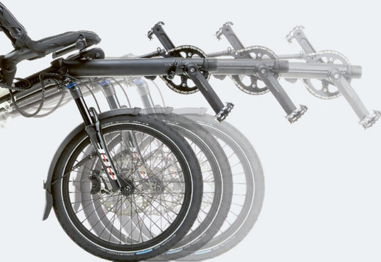
Das neue PINO hat einen teleskopierbaren Rahmen. Was das bedeutet? Dass man den Radstand verkürzen kann, indem man einfach den vorderen Rahmen in den Hauptrahmen schiebt. Wofür das gut sein soll? Zum Beispiel für ein wendiges Lastenrad mit dem Radstand eines gängigen Citybikes. Oder für ein Familienshuttle, das sich in Kellern, Garagen und an anderen Parkplätzen kurz macht. Oder für ein Tandem, das mit dem Radstand eines 29er-Mountainbikes auf jeden Heckträger passt. Dafür ist das gut!
