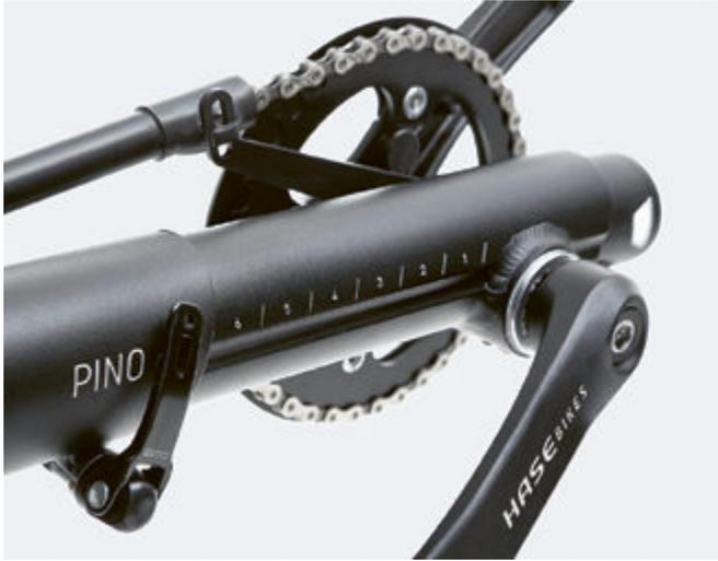
Der stabile Lenker wird in Swaging-Verfahren hergestellt. Er hat justierbare Anschläge für bevorzugte Einstellungswinkel und lässt sich mit nur einer Schraube lösen. Dann kann man ihn nach hinten in die Transportposition klappen. Ist der Liegesitz abgesteckt und das PINO maximal zusammengeschoben, dann passt es auf jeden gängigen Heckträger. Und damit auf fast jedes Auto!
