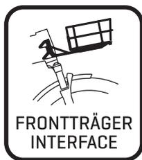
Modelle mit dem „Frontträger Interface“ verfügen über Anschraubpunkte am Steuerrohr zur Montage des Frontträgers. Entsprechende Modelle sind mit dem „Frontträger Interface Logo“ gekennzeichnet.
