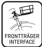
„Frontträger Interface“ zur Montage von Hercules Frontträger + Korberweiterung. Am Steuerrohr befinden sich seitlich Anschraub-Punkte für die Montage des speziellen Frontträgers von Hercules.
